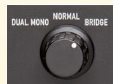
Am Aufbau der A-46 – mittiges Netzteil, Verstärkerelektronik außen – lässt sich kaum etwas verbessern (o.). Die beiden Endstufen (l. ein Kanal) lassen sich per Schalter (r.) zu Mono brücken oder für Bi-Amping auf einen Kanal schalten
