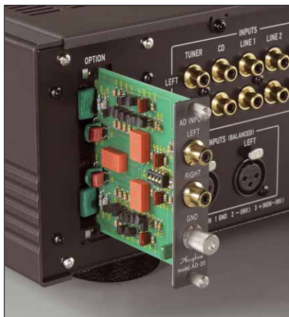
Im rückseitigen Schacht findet bei Bedarf das Phonomodul „AD-20“ Platz
