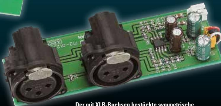
Der mit XLR-Buchsen bestückte symmetrische Eingang sitzt inklusive eines Operationsverstärker-Chips auf einer eigenen Platine
