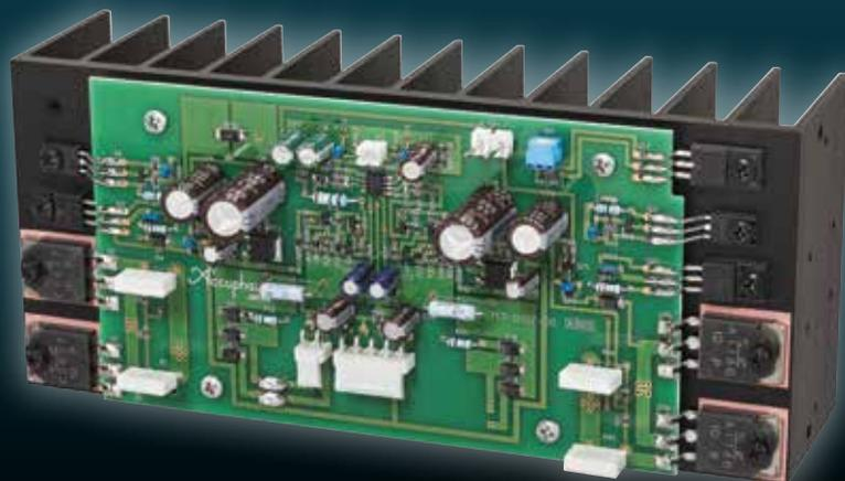
Die Schaltung der samt der Treiber auf den Kühlkörper montierten Leistungselektronik – hier ein Kanal – erlaubt eine vollsymmetrische Signalverarbeitung, wobei die vier Power-Transistoren links und rechts unten im parallelen Gegentakt arbeiten
