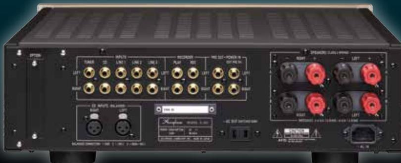
Der E-260 verfügt auch für den größeren Gerätepark über ausreichend Eingänge. Im Gegensatz zum Vorgänger E-250 bietet er einen geregelten Vorstufenausgang zum Beispiel für Bi-Amping-Konzepte. Die griffigen Kabelklemmen für den Boxenanschluss nehmen auch Bananenstecker auf
