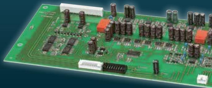
Statt eines Potentiometers bestimmt der „Accuphase Analog Vari-gain Amplifier“ die Lautstärke. Im E-260 setzt der Hersteller die noch präzisere sowie höher integrierte AAVA III-Version ein
