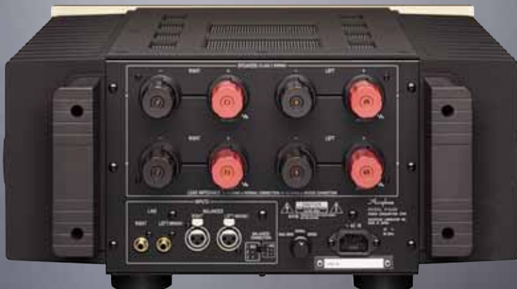
Auf der Baugruppe mit den Eingängen (o.) schalten kleine Relais zwischen Cinch und XLR um. Die großen Drehklemmen (r.) nehmen fette Querschnitte, Gabelschuhe oder Bananas auf. Auch auf der Rückseite bietet die P-6100 Griffe
