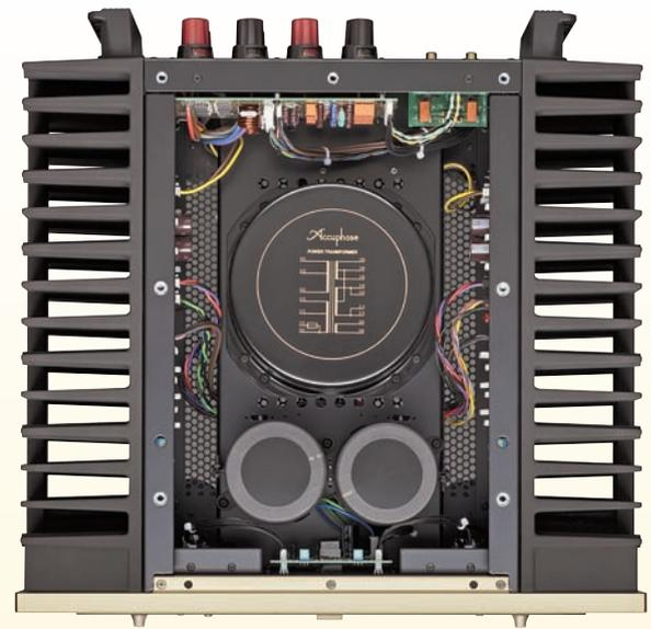
**Am Aufbau der A-46 – mittleres Netzteil, Verstärkerelektronik außen – lässt sich kaum etwas verbessern (o.). Die beiden Endstufen (l. ein Kanal) lassen sich per Schalter (r.) zu Mono brücken oder für Bi-Amping auf einen Kanal schalten**
